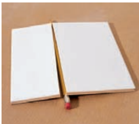
7 Den Schnitt in der Fliesenglasur legen Sie auf einem festen Untergrund genau über ein Rundholz (Bleistift) und brechen die Fliese.
