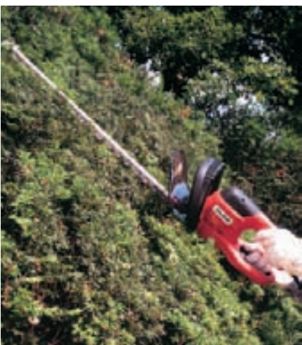
Gerade beim Schneiden zeigt sich, wie gut die Ergonomie der Heckenscherer ist. Drei-Griff-Lösungen wie hier bei der Dolmar-Heckenscherer ermöglichen eine größere Reichweite.
