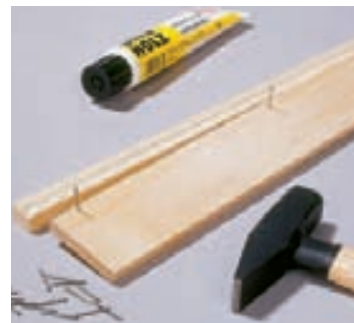
Die zwei Holzleisten werden mit etwas Holzleim und Nägeln im Abstand von 20 cm verbunden.
