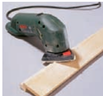
Die Kanten am besten mit einem Dreiecks- oder Schwing-schleifer brechen oder runden.
