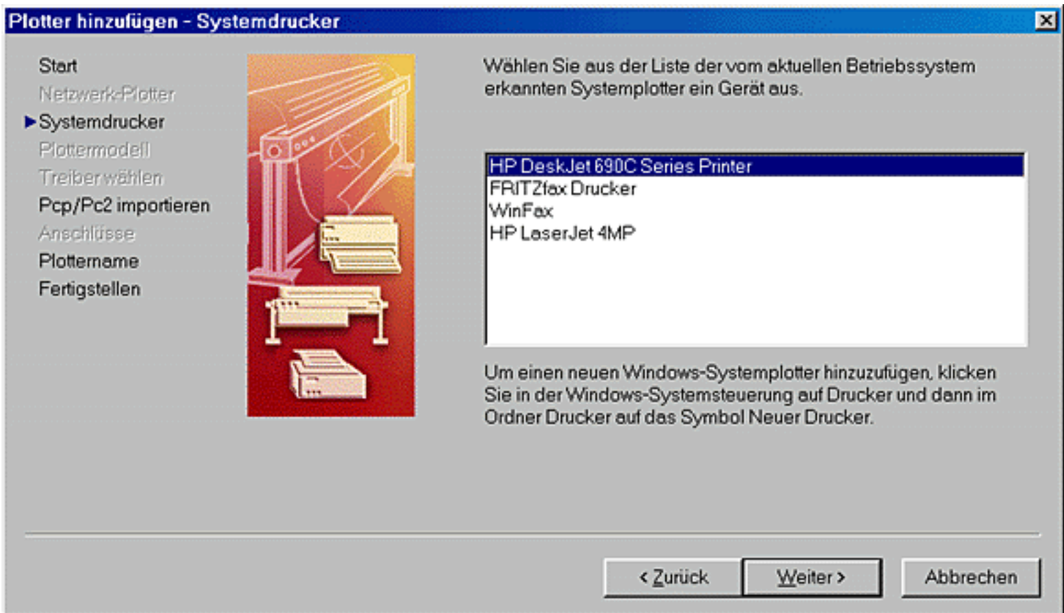
Bild 16.9: Assistent, um Plotter hinzuzufügen, Seite Systemdrucker
