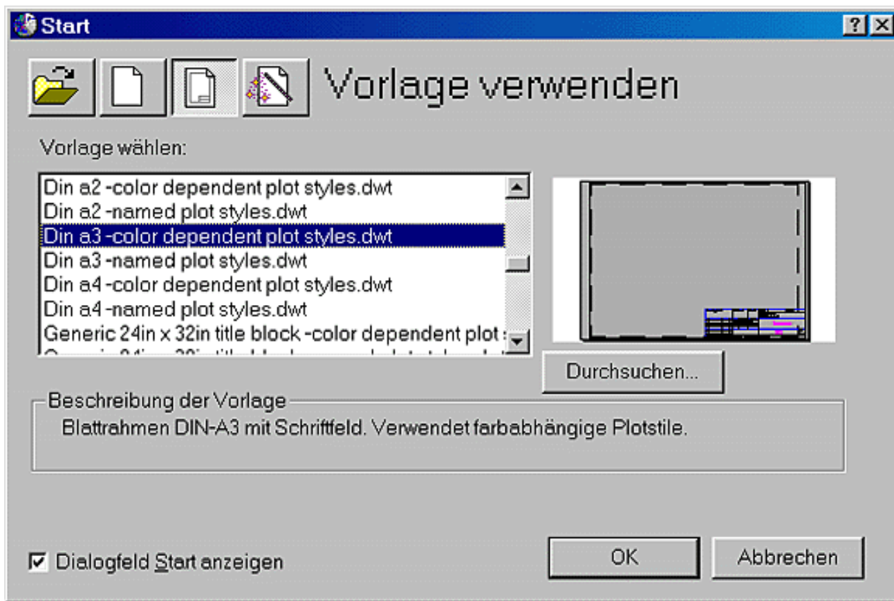
Bild 3.3: Start einer neuen Zeichnung mit einer Vorlage
