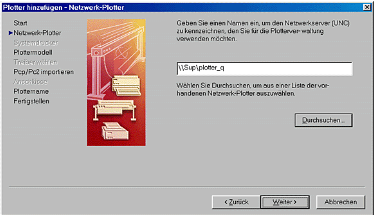
Bild 16.7: Assistent, um Plotter hinzuzufügen, Seite Netzwerk-Plotter
