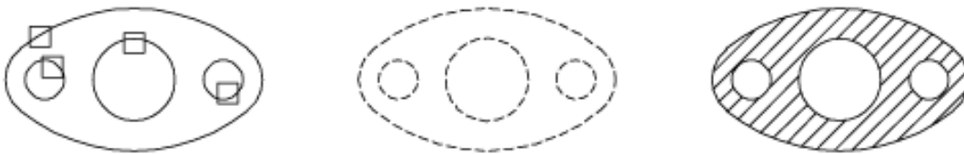
Bild 6.7: Ermittlung der Schraffurfläche
