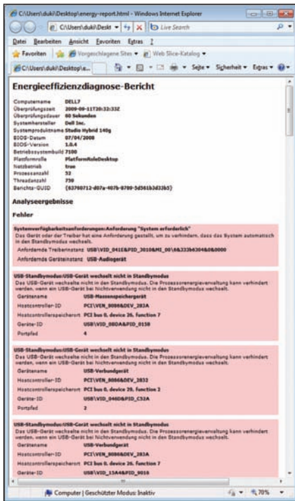
Bild 1: Der Energieeffizienzdiagnose-Bericht lässt sich per Webbrowser darstellen und zeigt, wie das untersuchte System effizienter mit Strom haushalten könnte
