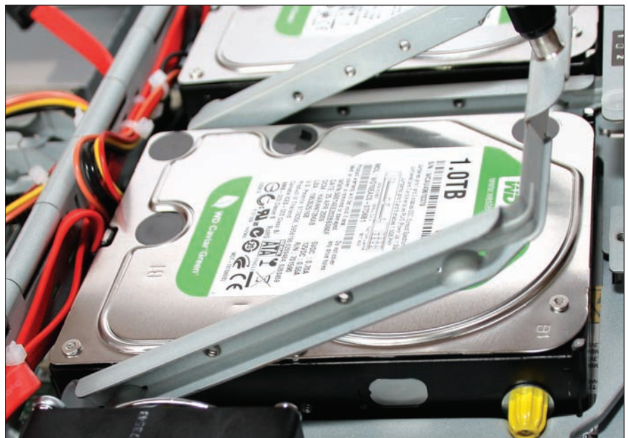
Bild 1: Die Festplatten werden mittels Klapp-Rahmen fixiert, die gelben Adapterstücke wirken schwingungsdämpfend
