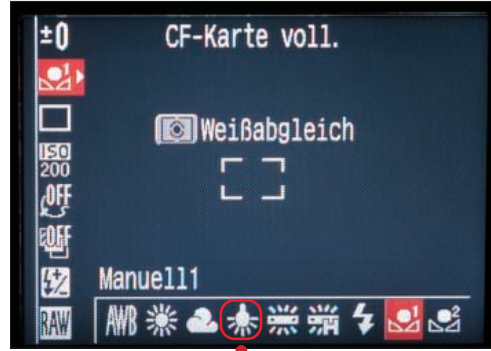
1 Wählen Sie im Menü des Weißabgleichs das Glühbirnensymbol für Kunstlicht. Die Kamera weiß jetzt, dass das Motiv von Kunstlicht beleuchtet wird, sie führt automatisch einen Weißabgleich durch.
