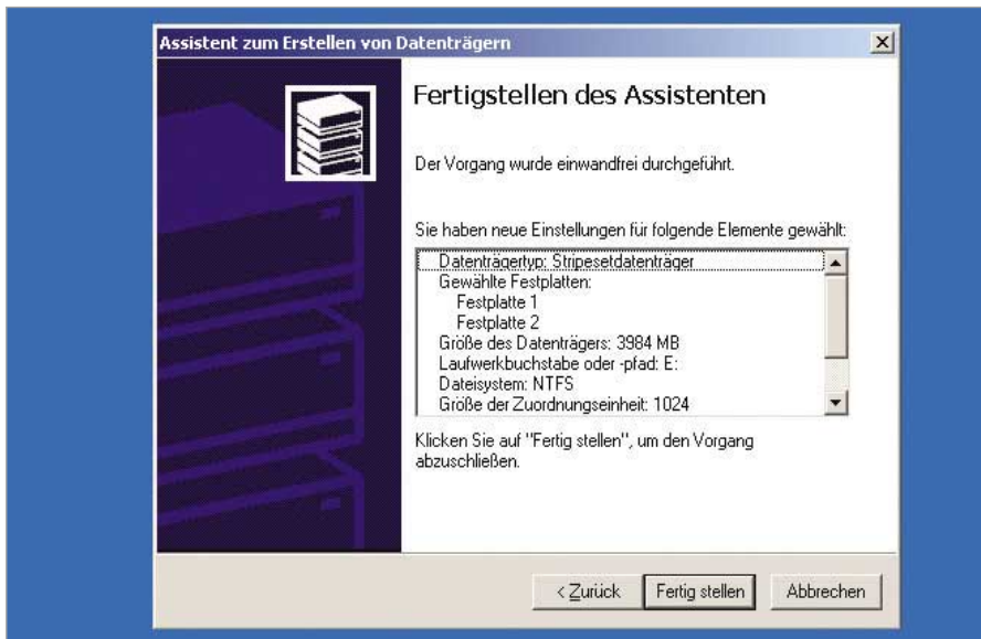
Mehr Geschwindigkeit mit zwei Festplatten: Der „Assistent zum Erstellen von Datenträgern“ unterstützt Sie beim Anlegen neuer Stripesetdatenträger (Punkt 2)
