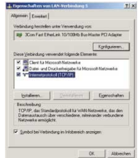
TCP/IP-Eigenschaften: Hier werden die IP-Adressen der Clients für die Router-Ansteuerung eingetragen
