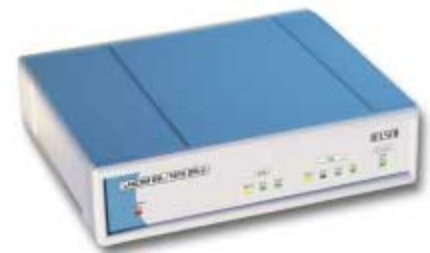
Immer informiert: Die Statusleuchten des Elsa-Routers zeigen den aktuellen Betriebsstand an
