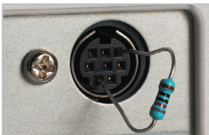
18 Überlistet: Der 820-Ohm-Widerstand gaukelt dem Epson-Scanner eine interne Durchlichteinheit vor.
