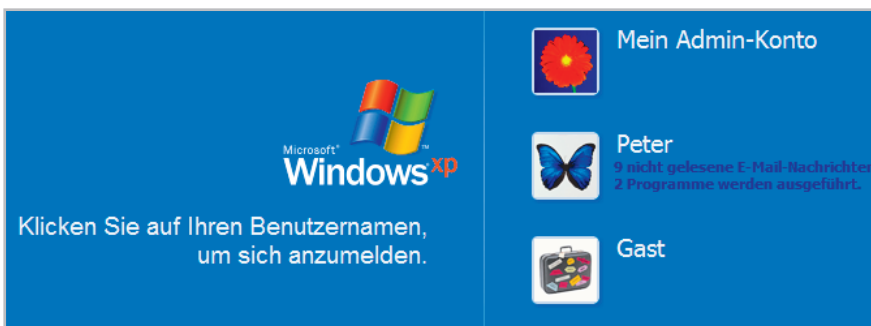
22 Informationspolitik: Über den Registry-Wert „MessageExpiryDays“ können Sie die Anzahl ungelesener E-Mails vom Anmeldebildschirm verbannen.
