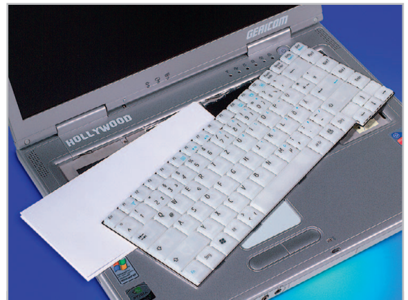
19 Aus labil wird stabil: Biegt sich ein schlappes Tastenfeld beim Tippen stark durch, einfach ein oder zwei gefaltete Blätter Papier unterlegen – fertig!
