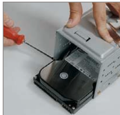
PLATTEN-KÄFIG: Beim Chieftec-Tower erfolgt der Platteneinbau bequem am Tisch – dank des abnehmbaren Einbaurahmens.
