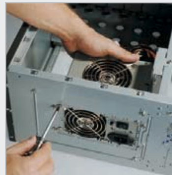
NETZTEIL-MONTAGE: Beim Chieftec-Tower TA-10BD wird unser Energiespender senkrecht eingeschraubt.
