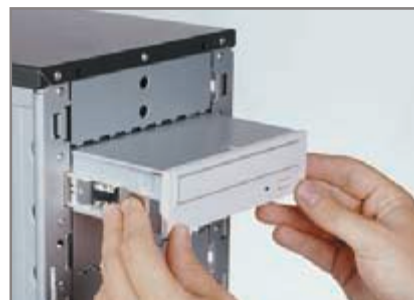
SCHUBKRAFT: Nachdem der DVD-Brenner geschickt wurde, kann er bequem in sein 5½-Zoll-Korsett schlüpfen.
