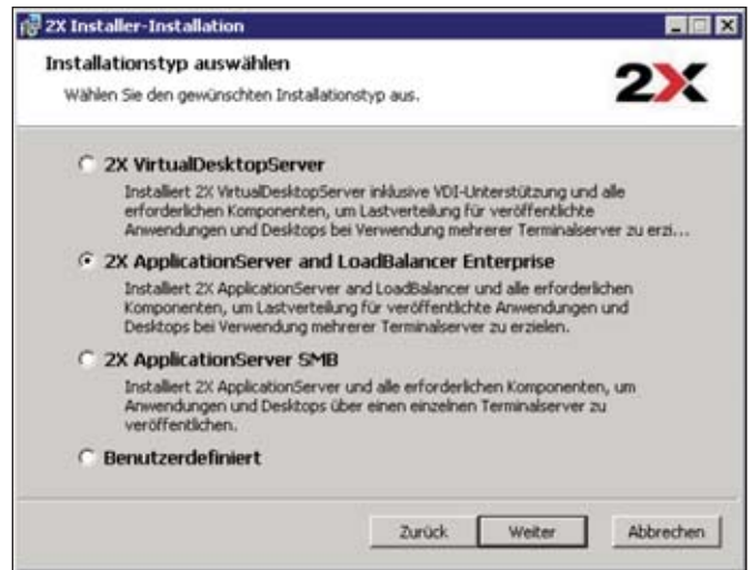
Bild 2: VDS und der Application Server sind in einem Setup zusammengefasst, die Lizenz entscheidet über den Nutzungsumfang
