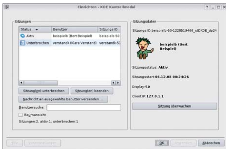
Bild 3: Für die X2go-Version 2.x gibt es auch ein KDE-Kontrollmodul, das beispielsweise Sitzungen verwalten kann. Es arbeitet aber leider nicht mit der aktuellen Version 3.0.x zusammen.
