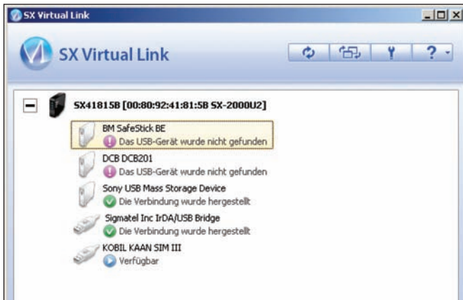
Bild 3: SX Virtual Link von Silex listet die bekannten USB-Geräte samt ihres Status sehr übersichtlich auf
