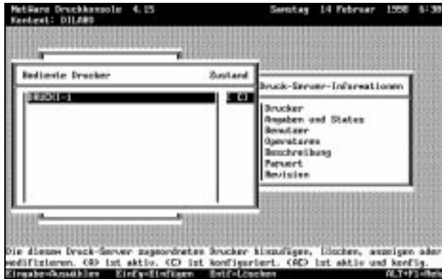
Abbildung 4: Druckerzuweisung an Druckserver
