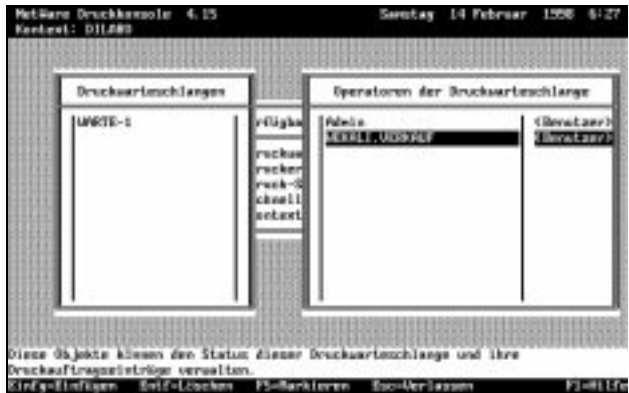
Abbildung 2: Die definierten Warteschlangen-Operatoren
