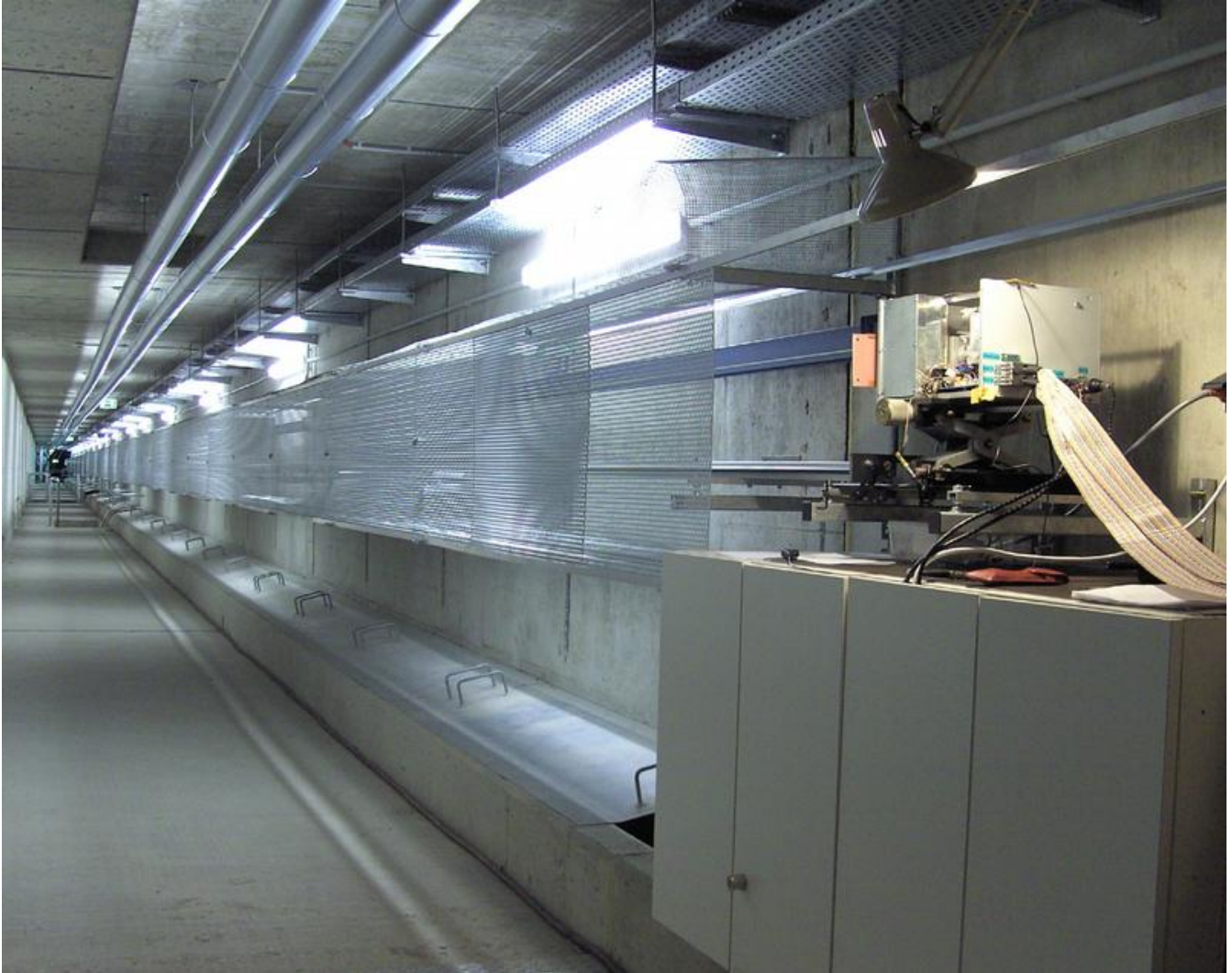
Der Laserscanner (rechts) bestimmt in einem Messkanal alle 0,5 Mikrosekunden den Abstand eines bis zu 80 Metern entfernten Objekts. © Fraunhofer IPM
