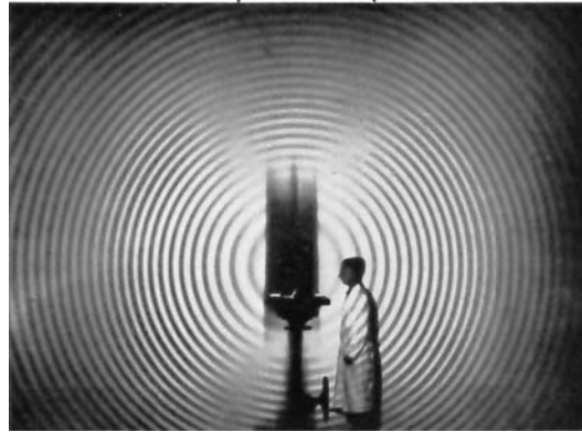
Abb. 440. Der hier dargestellte Interferenzversuch erzeugt ein räumliches Interferenzfeld mit einer planparallelen Platte und divergierenden Lichtbündeln. Das Bild zeigt einen Schnitt des Wandschirms mit diesem Interferenzfeld. Abstand zwischen Lampe und Platte einige Zentimeter, zwischen Lampe und Wandschirm etliche Meter. Längsbeobachtung gemäß Abb. 436. Man kann Stücke der Interferenzringe mit einem Mattglas noch dicht vor der Plattenoberfläche auffangen, wenn der Durchmesser 2y der Lampe klein genug ist. K2 (Videofilm 29) (Aufg. 85)
