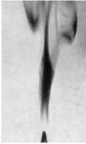
Abb. 604. Eine hell leuchtende, stark turbulente Flamme von Benzoldampf enthaltendem Erdgas wirft, vor den Kondensor eines Projektionsapparates gestellt, einen tief dunklen Schatten
