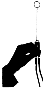
Abb. 140. Probespule zur Messung der magnetischen Flussdichte eines Elektromagneten. Eine Windung von 3 cm 2 Fläche, also Windungsfläche N_j A = 3 \cdot 10^{-4} m 2 .
