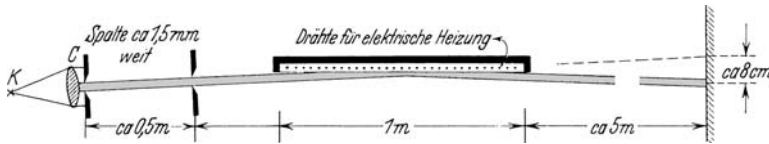
Abb. 345. Totalreflexion eines Parallellichtbündels an der Grenze zwischen heißer und kalter Luft. Bündel am rechten Ende etwa 2 cm dicker. K : Krater einer Bogenlampe.
