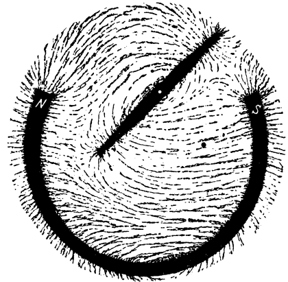
Abb. 2. Magnetische Feldlinien. Der Hufeisenmagnet SN dreht die Kompassnadel gegen den Uhrzeiger.
