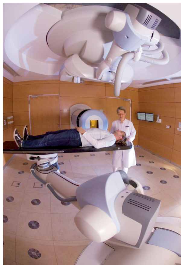
Abb. 8 Bestrahlungsraum am Heidelberger Ionentherapie-Zentrum. Der untere Roboter trägt den Patiententisch, der obere ein Kamerasystem zur Verifikation der Positioniergenauigkeit.
