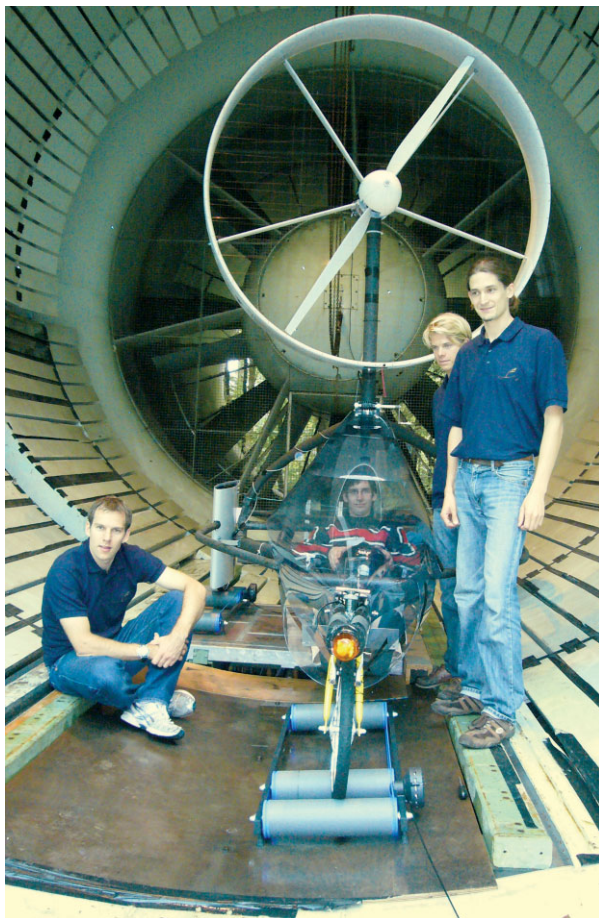
Abb. 5 Das Ventomobil im Windkanal (Foto: InVentus).
