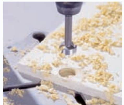
5 Mit einem Forstnerbohrer mit 35 mm Durchmesser wird nun im Bohrständer ein dem Scharnertopf entsprechendes Loch gebohrt.
