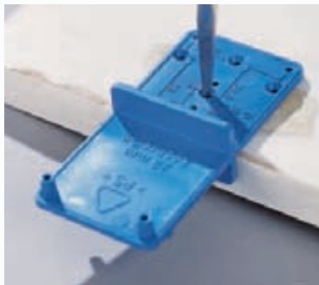
4 Mit einer Einbohrschablone (Hettich) wird der Bohrlochabstand zur Vorderkante, nämlich 21,5 mm, mit einem Vorstecher (Dorn) markiert.
