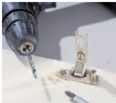
7 Die Löcher für die Direktbefestigungsschrauben werden mit einem Bohrer vorgebohrt, der etwas dünner ist als die Schrauben.
