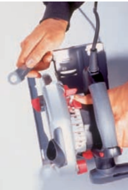
Eine Spindelarretierung wie hier bei der Skil Orca erleichtert den Wechsel des Sägeblattes.
