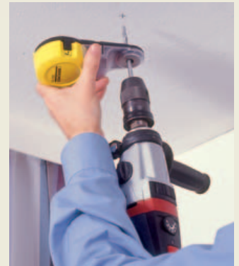
Zum Bohren in der Decke eignet sich der Kärcher-Bohrstaubfänger nicht, da der Staub dann nicht von allein in den Behälter fällt.
