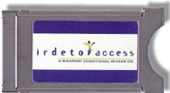
EIN SOLCHES PCMCIA-MODUL enthält die komplette Dekodierungstechnik für Pay-TV.
