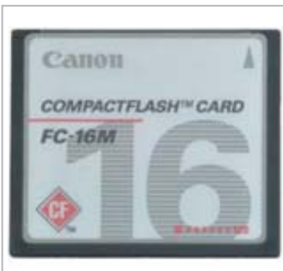
COMPACT FLASH: Die Speichermodule sind robuster und zeigen keine von außen zugänglichen Kontakte.
