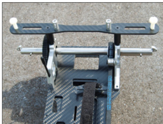
Differenziale gibt es beim Buri Racer nicht. Die Hinterachse ist starr
