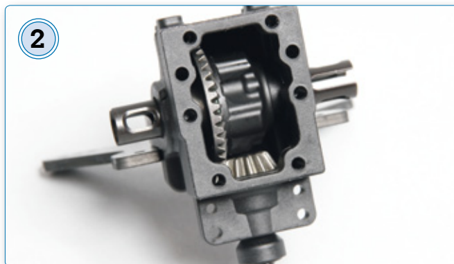
Einblick in das Getriebegehäuse
