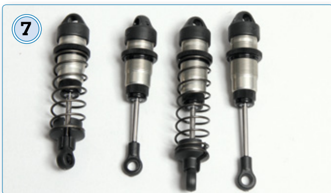
Die Big Bore-Stoßdämpfer des XB4. Sie sind gut verarbeitet und lassen sich mit den Tipps in der Anleitung luftfrei bauen
