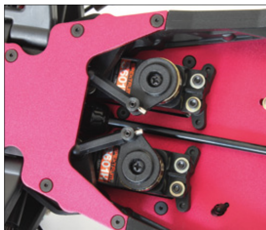
Wie üblich beim LST-XXL, stellen gleich zwei Servos die Vorderräder in die gewünschte Richtung
