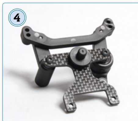
Die Lenkkonstruktion des XB4. Sie ist präzise und sehr leichtgängig
