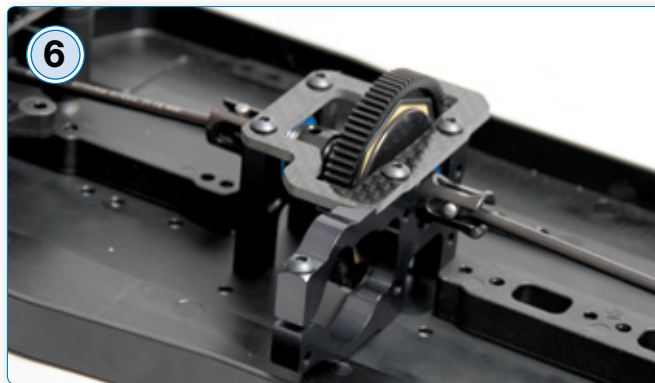
Der Slipper sitzt in der Mitte des Fahrzeugs. Alternativ kann man an seiner Stelle ein Kegeldifferenzial einbauen, das separat erhältlich ist
