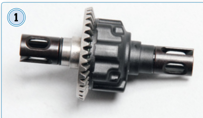
Eines der Kegeldifferenziale. Das Stirnrad ist aus massivem Stahl gefertigt. Die Ausgänge ebenfalls
