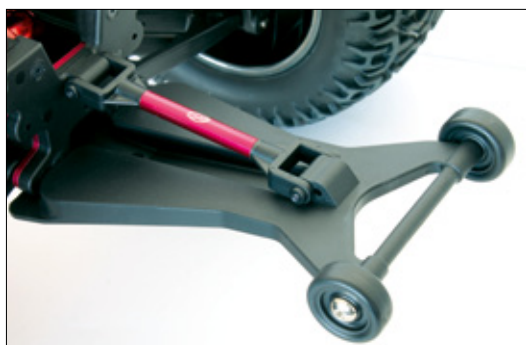
Die Wheelybar sieht nicht nur gut aus, sie verhindert auch Rückwärtssaltos, wenn man aus dem Stand Vollgas gibt
