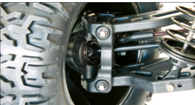
CVD-Wellen und Kugellager sind Serie – die E-Klipse leider auch
