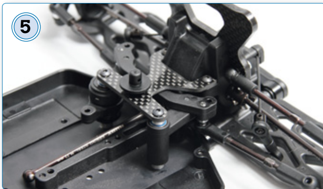
Die montierte Lenkung im Chassis. Eine kleine Kohlefaserplatte dient als Versteifung und als Befestigung für den vorderen Karosseriehalter
