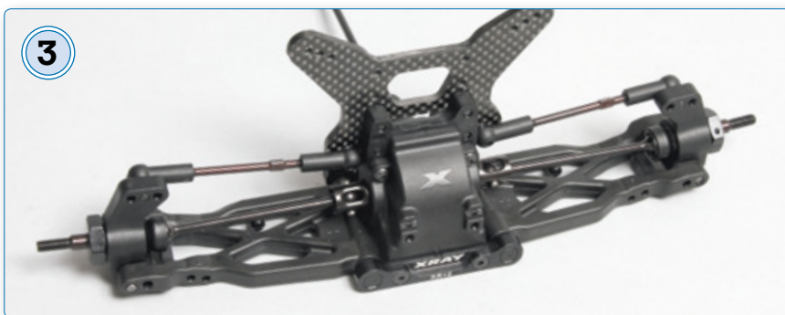
Die komplette Hinterachse. Die Kunststoffeinsätze am RR-Block und RF-Block (nicht sichtbar) verstellen die Vorspur und Spurbreite. Die oberen Querlenker verstellen den Radsturz und können an verschiedenen Punkten an Radträgern und Dämpferbrücken montiert werden
