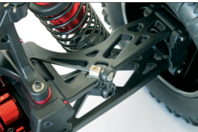
Neu beim LST-XXL 2 Electric sind die Stabilisatoren. Sie sorgen für ein ruhiges Fahrverhalten in Kurven
