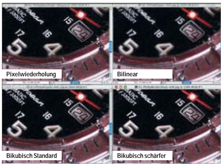
Man sieht auf diesem Vergleich 400-prozentiger Vergrößerungen von Photoshop, wie pixelig und treppentufig links oben die Pixelwiederholung ist, oben rechts mit Bilinear schon besser, aber weiterhin zu stark. Unten links Bikubisch Standard und unten rechts das neue Bikubisch schärfer, ohne aber dadurch pixeliger zu wirken.
