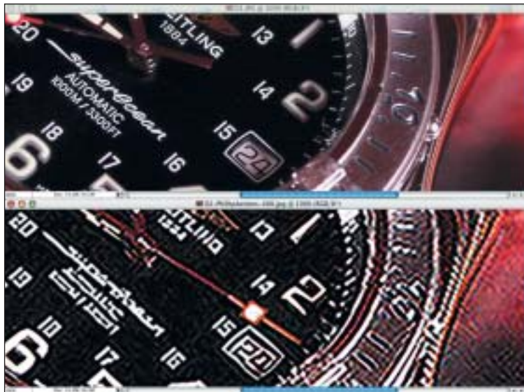
Die Ergebnisse der Interpolation sind nur begrenzt brauchbar: Oben das Bild in Originalauflösung fotografiert, unten das Foto in der gleichen Auflösung, die 400fach hochinterpoliert wurde. Es zeigt sich, dass bei der Interpolation starke Artefakte entstehen.
