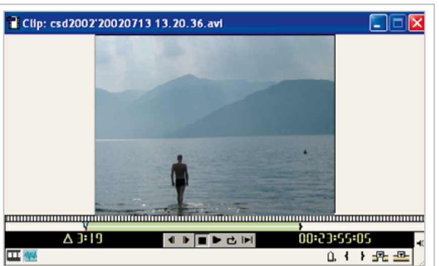
4 TRIMMFENSTER: Hier werden Clips gekürzt, indem Sie einen neuen Anfangs- und Endpunkt (hier: grüner Balken) definieren. Das Original bleibt davon unberührt.
