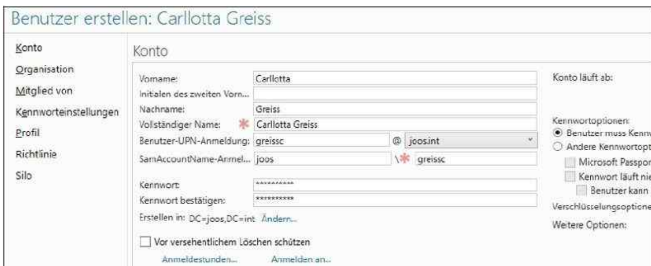
Abbildung 18.1: Neue Objekte im Active Directory-Verwaltungscenter anlegen
