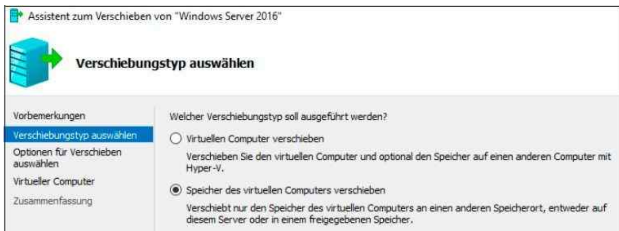
Abbildung 7.20: Verschieben des Speichers eines virtuellen Servers
