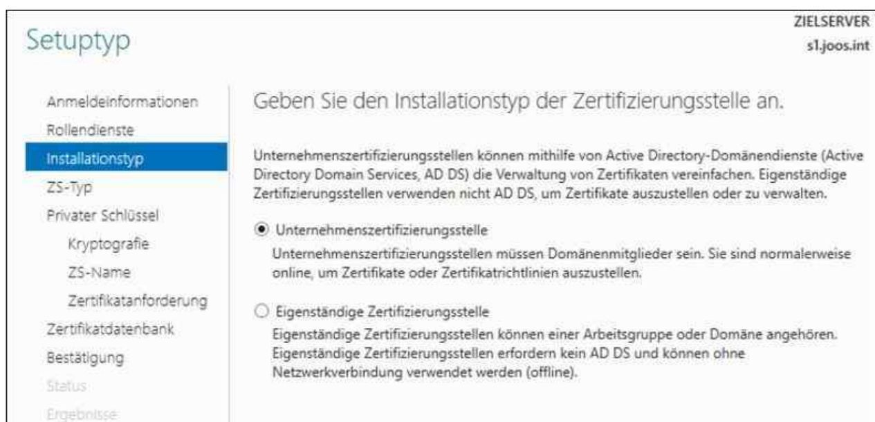
Abbildung 30.3: Den Installationstyp der Zertifizierungsstelle auswählen
