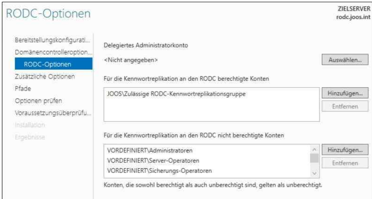
Abbildung 13.4: Festlegen der Benutzerkonten und Gruppen, deren Kennwörter auf den RODC repliziert werden
