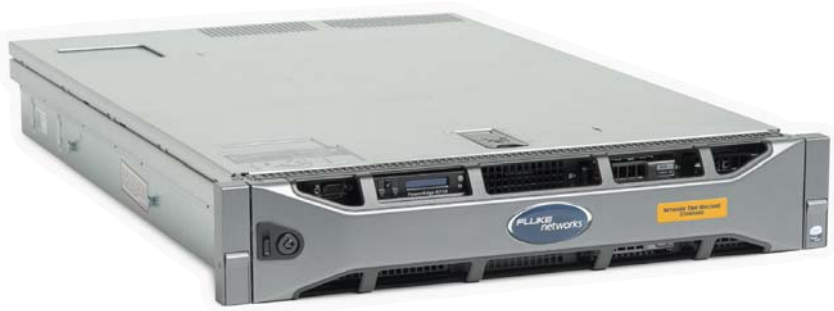
Bild 2: Troubleshooting-Werkzeuge wie das freie Wireshark oder für große Datenmengen die hier abgebildete Fluke Network Time Machine sorgen für valides Troubleshooting in UC-Umgebungen
