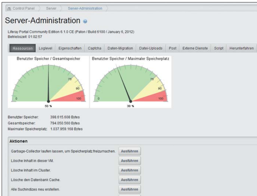
Bild 4: In der Server-Administration von Liferay steuern Sie beispielsweise Wartungsarbeiten.
