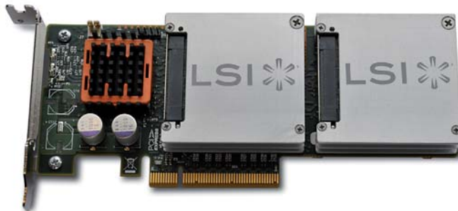
Dank Flash-Speicher on board beschleunigen die neuen Nitro-Karten von LSI den Datenfluss im SAN oder bei DAS
