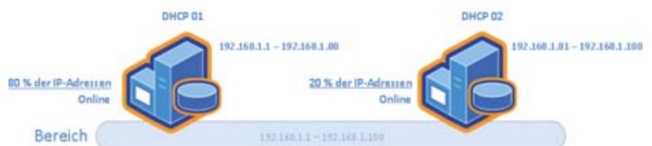
Bild 3: Beim DHCP-Split-Scope sind zwei DHCP-Server online und teilen sich die zu vergebenen IP-Adressen nach der 80/20-Regel
