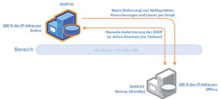
Bild 2: Im Szenario mit einem Hot-Standby-DHCP-Server muss der Administrator diesen beim Ausfall des DHCP-Servers manuell aktivieren
