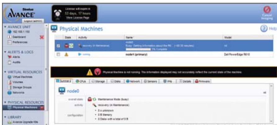
Bild 4: Ein Highlight von Avance ist die überaus einfache Wiederherstellung einer ausgefallenen Site oder Node per PXE-Boot und Imaging
