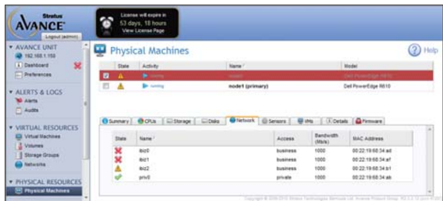
Bild 3: Bei einem Fehler kann der sekundäre Server problemlos in Wartung genommen und repariert werden, während die VMs auf dem primären weiterlaufen
