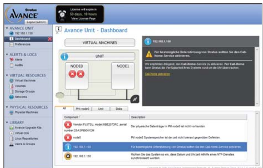
Bild 2: Das Dashboard der Avance-Konsole zeigt in einer Blockgrafik, wo sich eine ausgefallene Komponente befindet und listet Warnungen und Alarmer ihrer Schwere nach auf
