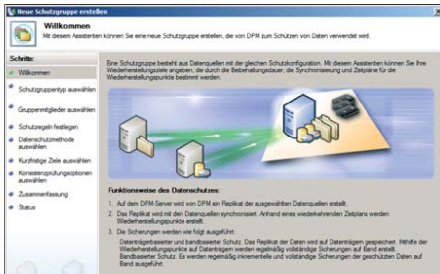
Die Sicherung erfolgt durch eine Definition von Schutzgruppen
