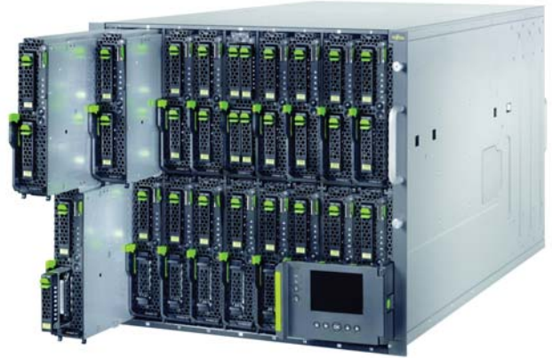
Insgesamt 18 Blade-Server bringt Fujitsu in der Chassis "Primergy BX900" unter
