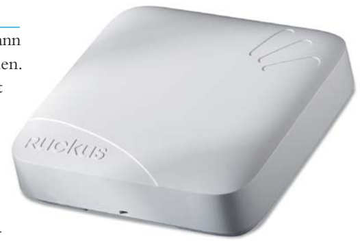
Der Access Point ZoneFlex 7982 bietet eine adaptive Antennenwahl und Beamforming
