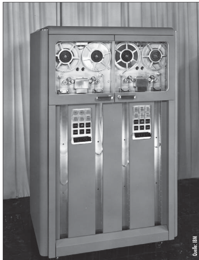
1,44 MByte Speicher auf dem schrankgroßen Magnetbandgerät IBM 726 nahmen eine Menge Raum im Rechenzentrum ein
