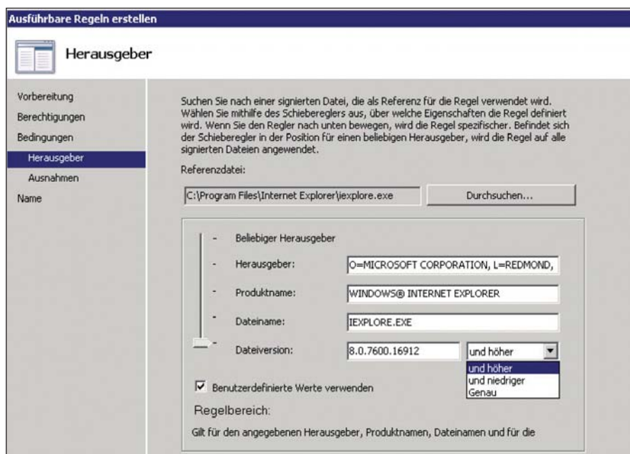
Bild 4: Die Auswahl der Filteroptionen für ein Programm erfolgt mit einem Schieberegler
