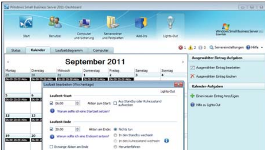
Bild 4: "Lights-Out" fährt den Server zeitgesteuert herauf und herunter
