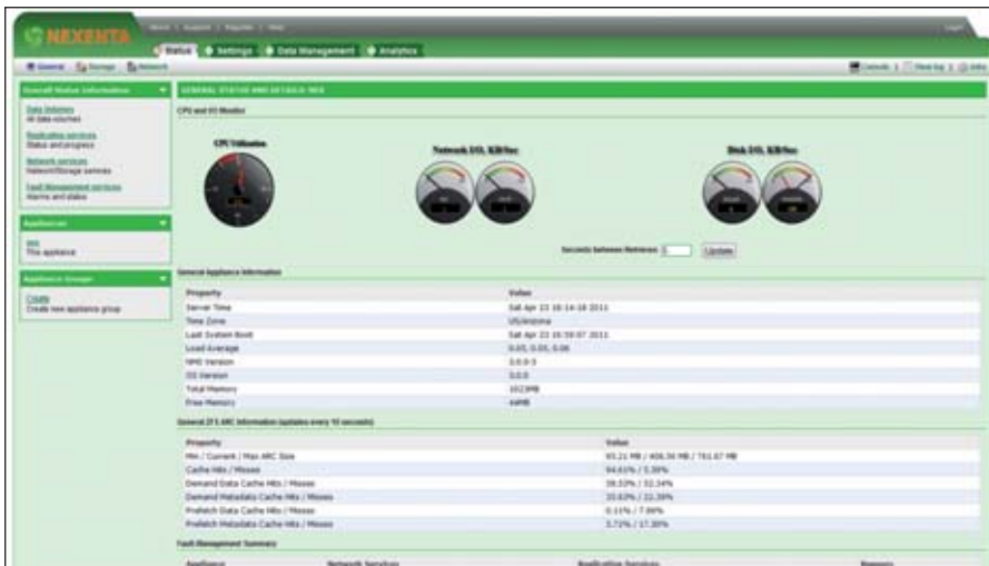
Über das Dashboard des freien Storage-Tools NexentaStor lassen sich Funktionen wie etwa die Deduplizierung steuern
