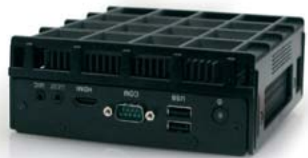
Der CONCEPT miniPC 325i setzt auf SSDs und FlashROMs für einen verlässlicheren Betrieb
