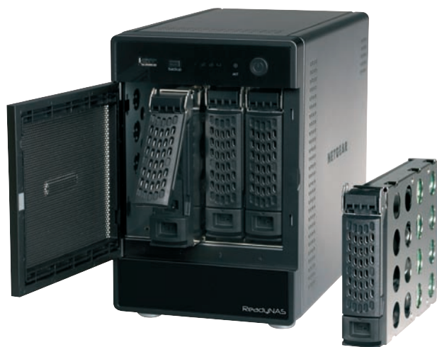
Einmal in die entsprechende Schiene geschraubt, lassen sich Festplatten bei den ReadyNAS Pro-Geräten auch im laufenden Betrieb austauschen
