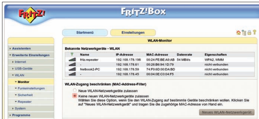
Bild 3: Wenn es der WLAN-Router erlaubt, nur bestimmte MAC-Adressen zuzulassen, können Sie die WLAN-Nutzung auf diese Geräte einschränken
