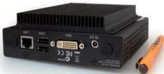
Die miniPCs von CONCEPT arbeiten lüfterlos und beinhalten einen NVIDIA-Grafikchip
