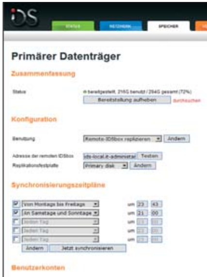
Bild 1: Die IDSbox im WAN muss anders konfiguriert werden als die im LAN
