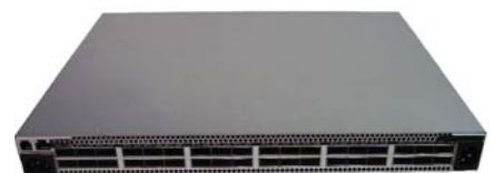
Der Infiniband-Switch 12200 von QLogic verfügt über 36 Ports und überträgt 40 GBit/s
