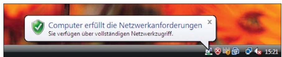
Bild 2: Auf den Computern werden Meldungen angezeigt, ob eine Netzwerkverbindung auf Basis der Richtlinien erlaubt oder verweigert wird
