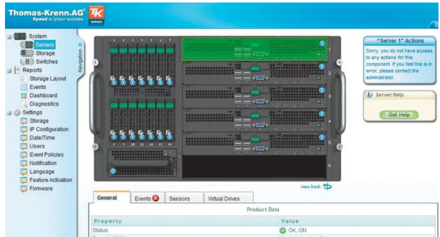
Die Front des Modular Server schmücken sechs Compute Modules und 14 Festplatten. Alle anderen Komponenten verstecken sich auf der Rückseite (Abb. 1).
