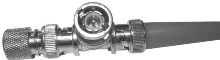
Abbildung 11.1 Die Abbildung zeigt ein T-Stück mit Anschluss für eine Netzwerkkarte. Rechts verläuft das Kabel weiter, links ist das T-Stück mit einem abschließenden Terminator versehen. Dies hier wäre also ein Ende eines Stranges. Die Stecker müssen nicht angeschlossen sein. Es empfiehlt sich aber, in kritischen Umgebungen bei unbenutzten Steckern eine Metallschutzkappe (HF-Schutz) aufzusetzen.
