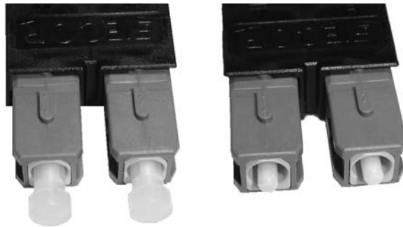
Abbildung 11.10 Unbenutzte Patchkabel und Dosen müssen mit Schutzkappen verschlossen werden, wenn sie nicht im Gebrauch sind. Dies verhindert ein Eindringen von Feuchtigkeit und Schmutzteilchen/Staub. Hier als Beispiel SC-Stecker mit (links) und ohne Schutzkappen.
