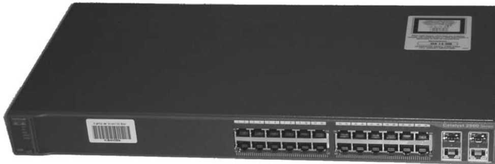
Abbildung 14.16 Ein Workgroup-Switch der Firma Cisco Systems mit 24 Access- und zwei Uplink-Ports. Die Uplinks sind Gigabit und können entweder über UGV oder mit speziellen Transceivern (SFP) an Glasfaser angeschlossen werden. Solche Geräte sind voll managebar, VLAN-fähig und geeignet, kleine bis größere Umgebungen zu erschließen.
