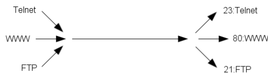
Abbildung 5.3 Multiplexing auf TCP-Ebene. Die Datenströme der Applikationen werden getrennt und den entsprechenden Ports (Applikationen) übergeben.
