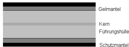
Abbildung 2.8 Der schematische Aufbau eines Lichtwellenleiters. Der Kern besteht aus dem das Licht leitenden Material. Er ist sehr dünn, mit dem bloßen Auge fast nicht zu sehen. Er wird von einer Kunststoffhülle gestützt. Diese ist von einem Gelmantel (oft aber auch ein Fadengeflecht) umgeben, der erlaubt, dass sich der Kern bewegen kann. Ganz außen ist eine Schutzhülle aus Kunststoff, die vor mechanischer Belastung schützt.
