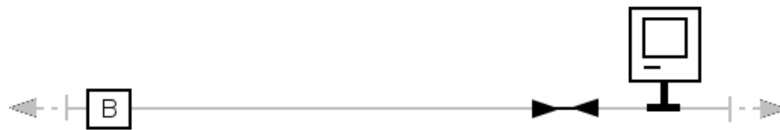
Abbildung 3.9 Zur Wiederholung, wir erinnern uns an Layer I: Hat das Signal das Medium fast ganz belegt, muss ein Sender, hier die Bridge B, nochmals dieselbe Signallaufzeit warten, bis er sich sicher sein kann, dass keine Kollision aufgetreten ist. Eine Station am entfernten Ende des Stranges könnte unter Umständen genau in dem Moment angefangen haben zu senden, in dem ihn das Signal gerade fast erreicht hatte. Bis der Sender die Kollision bemerkt, vergeht nochmals die gesamte Laufzeit.
