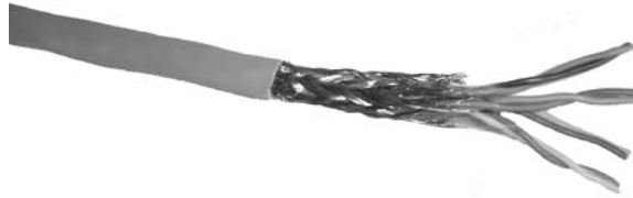
Abbildung 2.6 Hier ein aufgeschnittenes Kabel des Typs S/UTP. Deutlich sieht man die einzelnen in sich verdrehten Adernpaare. Um die Adernpaare liegt ein Mantel aus Metallgeflecht zur Abschirmung. Dies ist zwar teurer als Metallfolie, macht das Kabel aber beweglicher.
