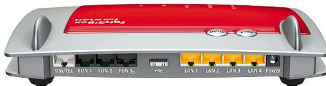
Die AVM Fritz!Box Fon WLAN 7390 (ca. 220 Euro) unterstützt DSL bis Gigabit-LAN, bietet vier LAN-Ports und funkt im Dualband-Betrieb
