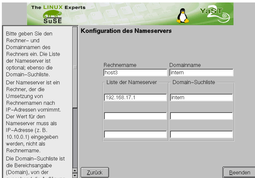
Abbildung 9.5: Konfiguration des DNS-Clients unter SuSE
