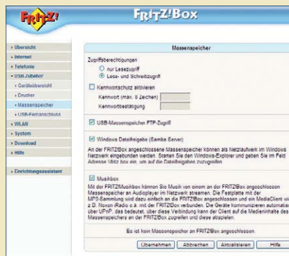
Daten streamen: Die FritzBox lässt sich mit der Labor-Firmware auch als Datei- und Streaming-Server verwenden.
