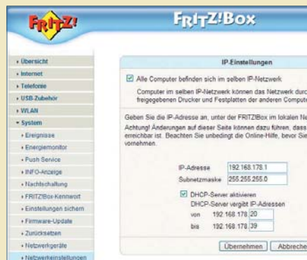
Reichweite erhöhen: Aktivieren Sie auf Basisstation und Repeater „Alle Computer befinden sich im selben IP-Netzwerk“.
