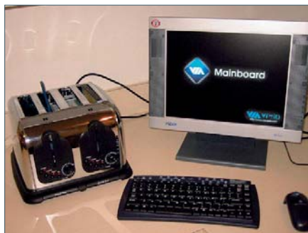
Toaster-PC: Ein Mini-ITX-Board bringen Sie sogar problemlos in einem ausgedienten Brotkröster unter.
