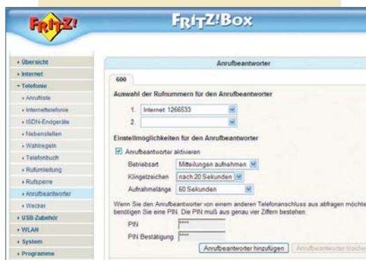
Telefonie optimieren: Der Anrufbeantworter erlaubt pro Rufnummer eine eigene Mailbox inklusive Fernabfrage.
