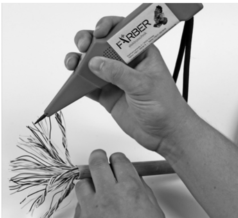
Abbildung 2.30 Arbeiten mit dem Tastkopf an einem Adernbündel
