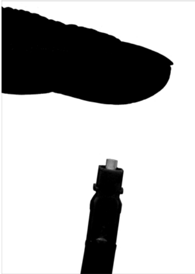
Abbildung 2.40 Hier droht Gefahr für LWL-Komponenten!
