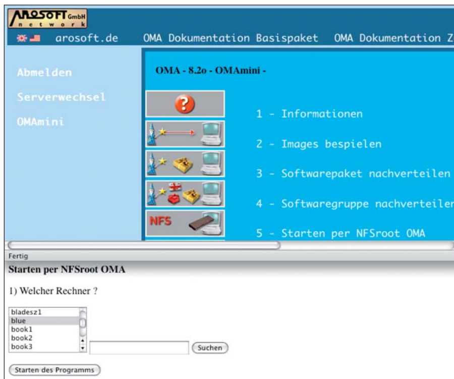
Bild 2: Beim Starten per NFSroot fragt der Management-Server von OMA nach, welchem Rechner das Booten vom Netz erlaubt werden soll
