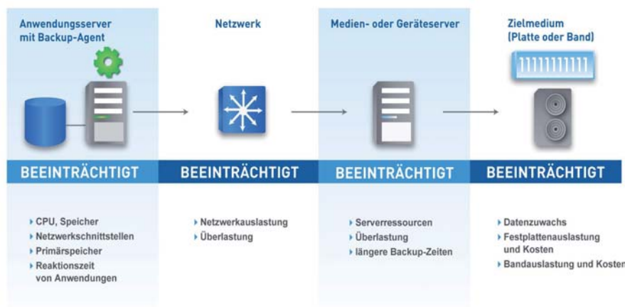
Bild 1: Die traditionelle, File-basierte Datensicherung wirkt sich nahezu auf alle Komponenten der IT-Landschaft negativ aus
