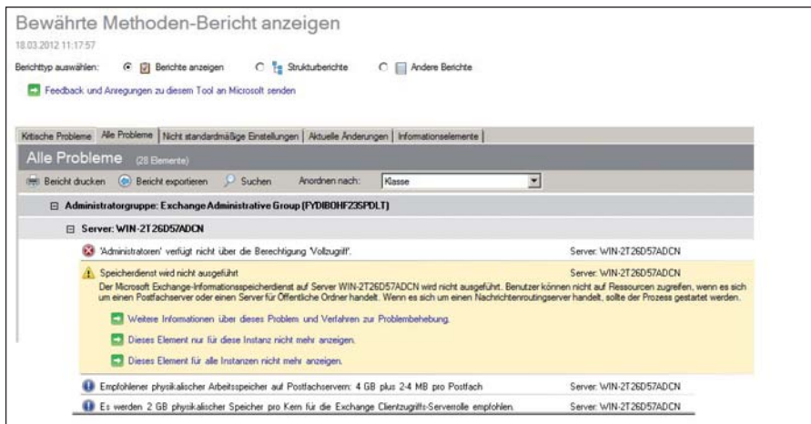
Bild 3: Sie können in der Ansicht des ExBPA wählen, welche Probleme angezeigt werden sollen
