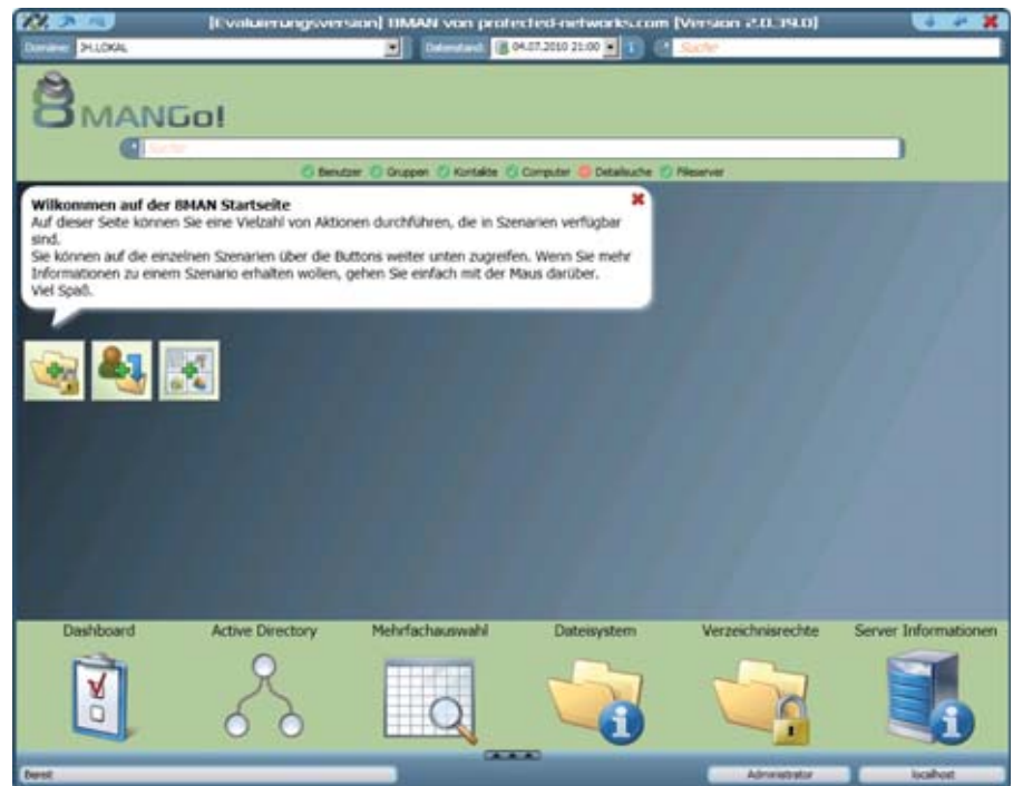
Bild 1: Das Hauptmenü von 8MAN erlaubt den Einstieg über typische Szenarien oder über die sechs Icons direkt in die einzelnen Funktionsbereiche
