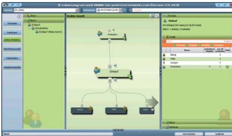
Bild 4: Der Active Directory-Browser zeigt die Zusammenhänge zwischen den Objekten übersichtlich an und hilft auch bei der Analyse von Fehlern wie hier einer Rekursion
