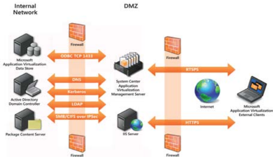
Bild 2: So sieht der Aufbau der Infrastruktur aus, wenn Sie Anwendungen mit App-V über das Internet streamen wollen
