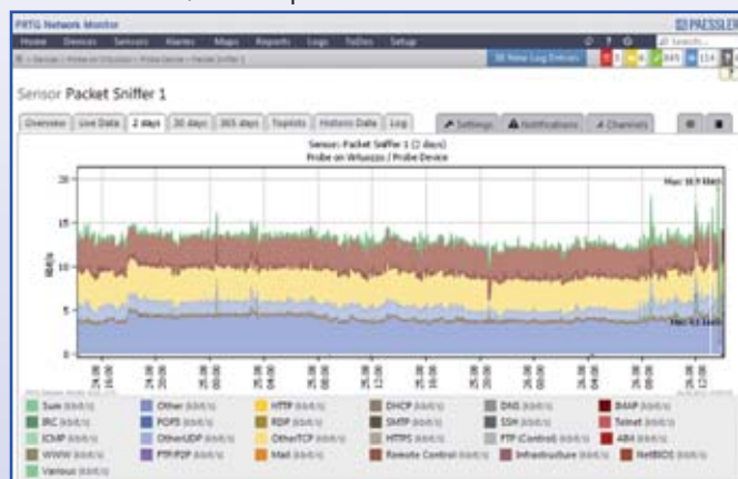
Packet Sniffer-Sensoren analysieren den Traffic nach Protokollen und stellen die gesamte Bandbreitennutzung anschaulich dar.
