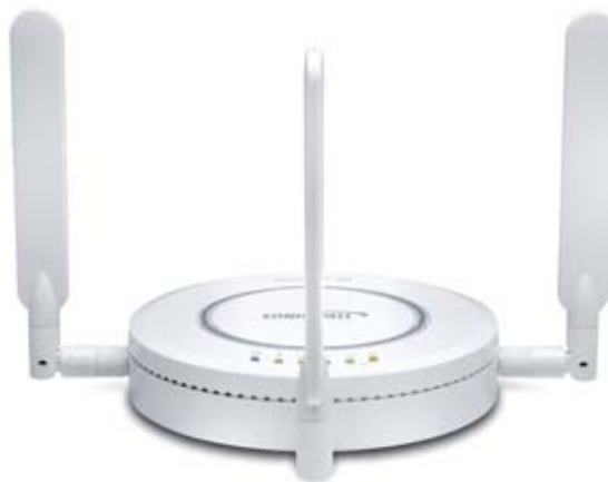
Der Access Point SonicPoint-Ne von SonicWALL lässt sich wahlweise per PoE oder Netzkabel mit Strom versorgen
