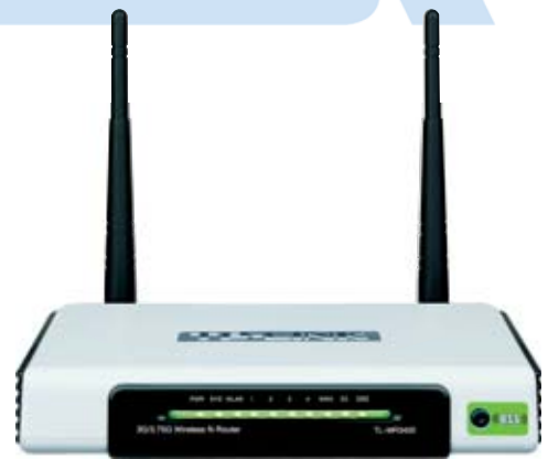
Der Router TL-MR3420 von TP-LINK lässt sich redundant ans Internet anbinden
