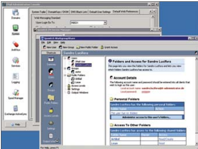
Bild 5: Über drei separate Management-Konsolen werden die verschiedenen Funktionen administriert
