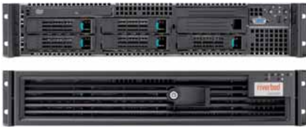
Die Appliance "Cascade" von Riverbed misst über einen Software-basierten Sensor auch die Anwendungs-Performance in Außenstellen
