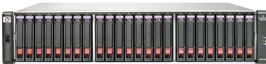
Das SAN-Modul "MSA2300fc G2" fasst bis zu 60 TByte Daten
