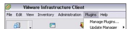
Bild 1: In einem eigenen Menü lassen sich ab Version 2.5 des VirtualCenter Plug-ins aktivieren und verwalten
