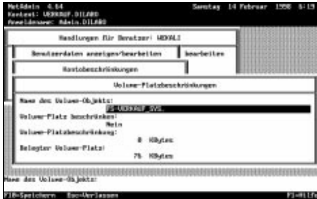
Abbildung 1: Speicherplatzbeschränkung eines Benutzers
